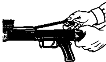
Рис. 52. Отделение возвратного механизма
