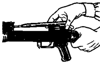
Рис. 53. Отделение затворной рамы с затвором
